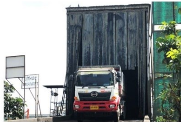
เครื่องดูดและจับเก็บฝุ่นจากการเทสินค้า
