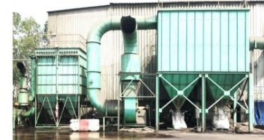
เครื่องดูดและจับเก็บฝุ่นจากการเทสินค้า
